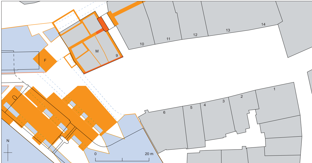
Abb. 39 In den frühen 1780er-Jahren wird der untere Abschluss des Mühlenplatzes neu gestaltet: Das Müllerhaus wird abgebrochen, der Gebäudekomplex der Münz (M) erhält eine neue Fassadenflucht, Mühlen und Spreuerbrücke werden neu gestaltet, und westlich der Münz wird die „Fässersinne“ (Eichstätte) errichtet (F).
