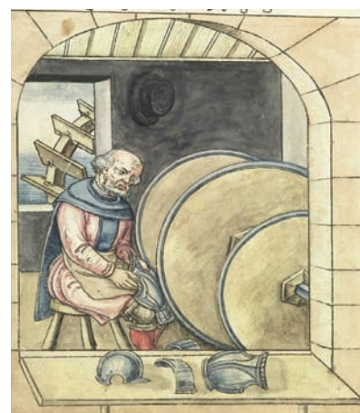
Abb. 32 Der Harnischer bei der Arbeit an seinem mit einem Wasserrad betriebenen Polierapparat. Zeichnung von 1572 aus dem Hausbuch der Mendelschen Zwölfbrüderstiftung zu Nürnberg.
